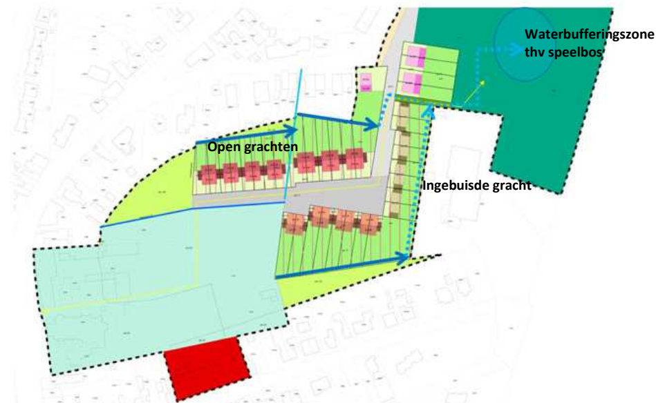
Figuur 1: voorstel afwatering hemelwater
